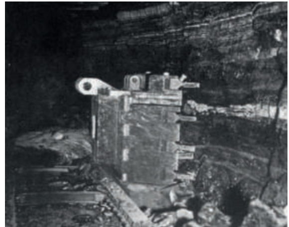
Abb. 13: Reishakenhobel mit Panzerförderung im Flöz 10/11.
